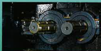
Boîtier inverseur intégré avec limiteur à boulon de rupture
