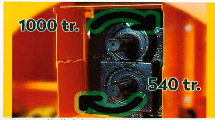
HD Umkehrgetriebe 1000/540U/M Ideal zur Frontmontage
